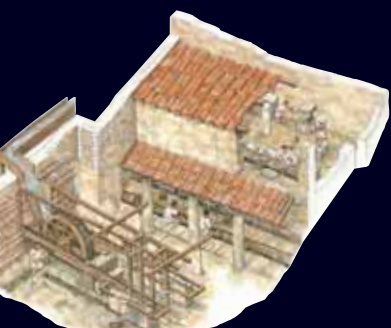
Steinsäge Mit riesigen Maschinen konnten Marmorblöcke in Platten für Wände und Böden gesägt werden. © Mainz, RGZM, Grafik: M. Ober
