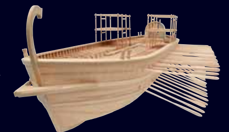
Dromone (Rekonstruktion) Modell eines byzantinischen Kriegsschiffes aus dem 9./10. Jh., das auch mit Flammenwerfern ausgerüstet sein konnte. © Mainz, RGZM, Museum für Antike Schifffahrt, Foto: V. Iserhardt, R. Müller
